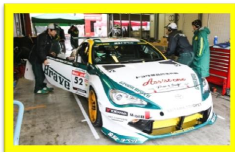
▲合同テストの様子。グリル内の黄色のテープでエンジンの冷え方を調整しています。
