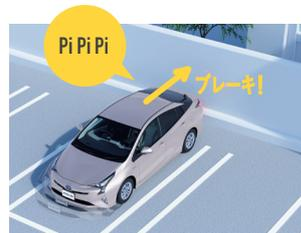
ソナーはカメラと違い、障害物がガラスでもしっかり感知。バックも含め前後方向に対応しています。トヨタが考える安全技術の基本はドライバーの意志を尊重し、ドライバーのアクセル・ブレーキに応じて支援しますが、ICSは目の前の壁との衝突を避けることを最優先に、唯一、ドライバーがアクセルを踏んでも自動でブレーキをかける安全装備です。
